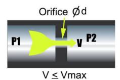
Ainsi, lorsque les conditions pour atteindre la vitesse maximale ou sonique sont atteintes, peut importe ce que l'on fait : augmenter la pression à l'entrée de l'orifice, réduire, voir même faire le vide du côté sortie de l'orifice, la vitesse de déplacement du gaz n'augmentera plus, mais restera constante à Vmax.
