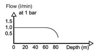
Et alors que nous allons de plus en plus profond, 70 m, 80 m... la pression de l'eau P2 va augmenter et se rapprocher de P1 (la MP), la vitesse du gaz continuant de chuter de même que le débit massique, jusqu'à atteindre 90 m. À ce moment la pression dans l'eau est égale à la moyenne pression (tous deux à 10 bar), il n'y a plus de différence de pression de part et d'autre de l'orifice, donc pas de flux de gaz à travers celui-ci, le débit massique est tombé à zéro.
