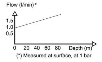
On remarque que plus on va profond, en utilisant notre système avec un détendeur normal relié à notre bouteille d'O2, plus le débit massique d'O2 (ainsi que le débit volumique mesuré à 1bar) augmente : nous n'avons pas un flux massique d'oxygène constant.
