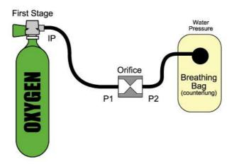
La pression à la sortie du premier étage, la moyenne pression (MP), est fixée à 10 bar de pression absolue. Sur cette sortie nous fixons un orifice d'un diamètre fixe et la sortie de l'orifice débite dans le sac respiratoire de notre recycleur.
