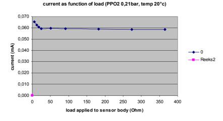
Nous nous apercevons que même si nous changeons la charge (la résistance) sur une large échelle (de  $20\Omega$  à plus de  $500\Omega$ ), le courant fourni ne change quasiment pas! Ce premier test montre qu'en fait la cellule galvanique est une source de courant (et non une source de
