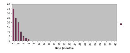
Il montre clairement que nous avons à faire à un mauvais lot de fabrication, les capteurs commencent à cesser de fonctionner dès leur mise en service dans le recycleur sans raison apparente, mis à part quelques défauts internes?
