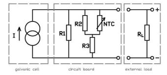
À gauche nous avons la cellule galvanique (la source de courant), au milieu le réseau résistif que nous trouvons sur le circuit imprimé et sur la droite la charge résistive externe que le fabriquant du capteur recommande de placer là où la mesure se fait.
