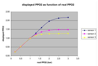
Regardons le capteur n°2: nous remarquons que la sortie est linéaire jusqu'à une PpO<sub>2</sub> de 1bar. Supposons que l'on calibre à l'oxygène pur (au niveau de la mer) et qu'à tort nous croyons avoir un bon capteur: linéaire jusqu'à une PpO<sub>2</sub> d'au moins 1,6bar.
