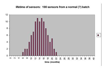
Avec ce que nous savons, quand devrons nous changer les capteurs dans notre recycleur? Ce n'est pas si clair que ça parce que nous ne savons pas à l'avance quel capteur va cesser de fonctionner. Cela dépend du lot de fabrication et surtout comment le capteur va être «traité»!
