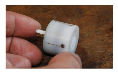
Sur la face inférieure du capteur on aperçoit une membrane blanche: c'est par là que l'oxygène passe.
