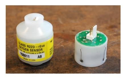
Sur la gauche vous apercevez un capteur d'oxygène complet, sur la droite l'intérieur du capteur quand l'enveloppe de protection externe est enlevée. Sur le dessus de la partie interne on voit un circuit imprimé avec en son centre un connecteur (ici de type Molex mais il en existe d'autres types), la partie blanche en dessous étant le corps du capteur (la cellule galvanique) d'où sortent deux fils de connexion allant au circuit imprimé.
