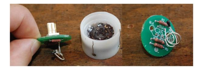
Lorsque l'on enlève le circuit imprimé, on aperçoit des composants électroniques montés sur la partie inférieure. L'autre partie est la cellule galvanique ou partie électro-chimique composée d'une membrane transparente souple qui recouvre les électrodes baignant dans un liquide.
