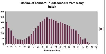
Vous voyez sur la partie gauche de la courbe la plus grande probabilité de défaillance d'un capteur après installation (<u>type 2</u>) et plus à droite la décroissance typique due à l'âge (<u>type 1</u>).
