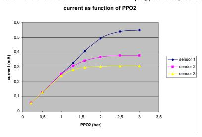
Pour le capteur n°1, nous voyons que le courant augmente linéairement jusqu'à une PpO<sub>2</sub> d'environ 2bar et que cette courbe commence alors à s'aplatir: la cellule galvanique ne peut plus fournir assez de courant. Nous parlons alors d'une limitation en courant du capteur, il y a une limite à ce que le capteur peut fournir.
