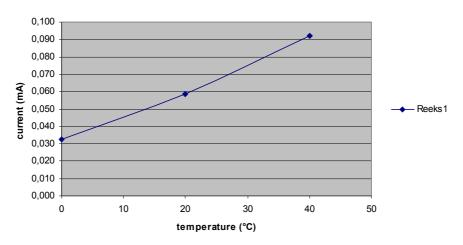
Nous voyons que lorsque l'on augmente la température le courant fourni par la cellule augmente également. Par contre cette augmentation n'est pas linéaire. C'est typiquement un effet qu'on désire ne pas avoir sur un capteur mesurant la PpO<sub>2</sub>.
